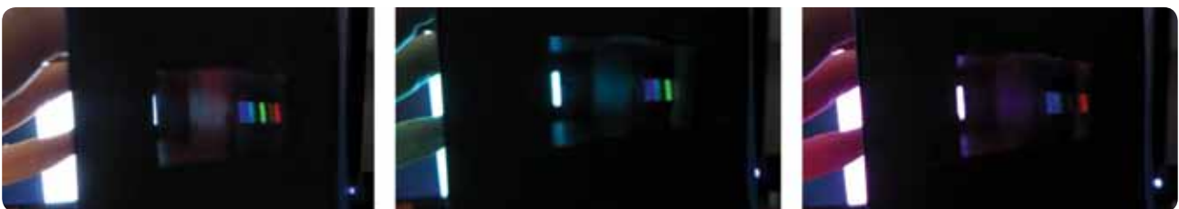
Slika 4: Pogled skozi spektroskop ob opazovanju svetlobe, ki jo oddaja zaslon.
