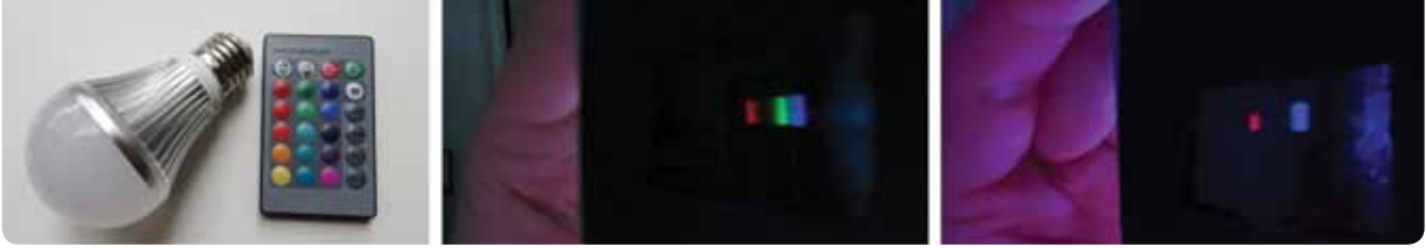
Slika 3: Žarnica RGB LED z daljinskim nastavljanjem barve svetlobe (levo). Pogled skozi spektroskop ob prižgani beli (sredina) in magenta barvi LED žarnice (desno).
