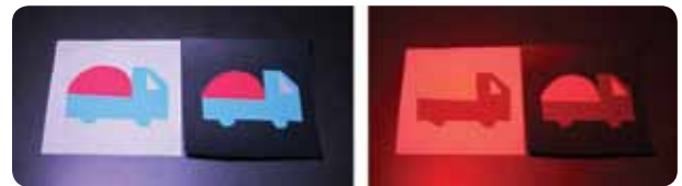
Slika 5: Kolaž tovornjaka na beli in na črni podlagi, osvetljen z belo svetlobo (levo) in z rdečo svetlobo (desno).
