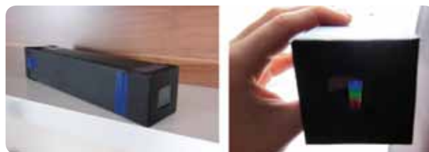
Slika 1: Spektroskop (levo). Fotografija zveznega spektra ob opazovanju sončne svetlobe skozi spektroskop (desno) (Susman, 2014).
